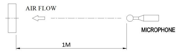
1 METER FROM MICROPHONE TO FAN INTAKE
